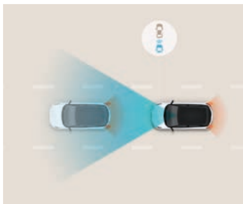
Sistema de asistencia a la frenada de emergencia (FCA). El sistema FCA te avisa y activa automáticamente el freno si detecta un frenazo repentino en el coche que circula delante o percibe peatones en la vía.
