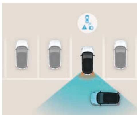
Alerta de aproximación de tráfico trasero activo (RCCW). Al dar marcha atrás en zonas de poca visibilidad, el sistema avisa al conductor si se aproximan vehículos por el lateral (disponible en la versión Hatchback).
