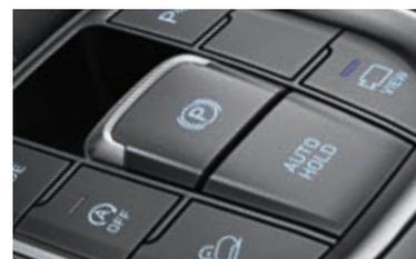
Sistema de freno de estacionamiento eléctrico (EPB)
