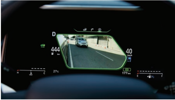
Assistenza angolo morto con feedback video nel quadro strumenti
