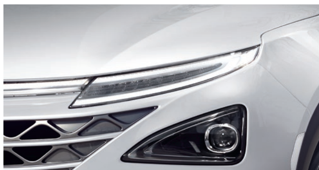
Blocs-feux composites à double étage
