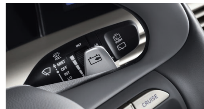
Palettes au volant (régulation du niveau de freinage par récupération)
