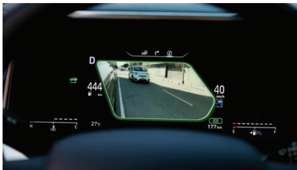
Assistant d'angle mort avec retour vidéo dans le combiné d'instruments
