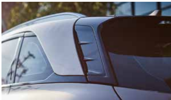
Luftkanal i D-stolpene
