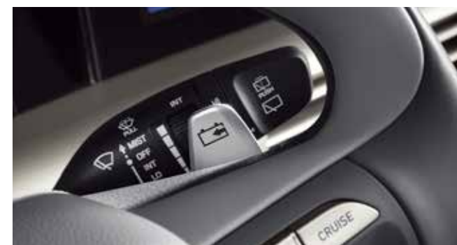
Hendler på rattstammen (regenerativ bremsing)
