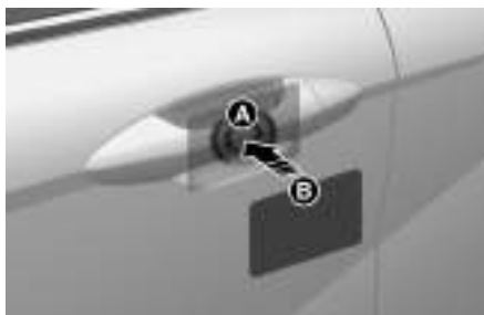
[A] Autentizační podložka v klince dveří [B] Anténa NFC kartového klíčku
