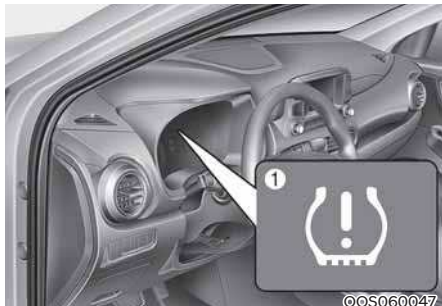
(1) Kontrolka nízkého tlaku vzduchu v pneumatikách / kontrolka poruchy TPMS
