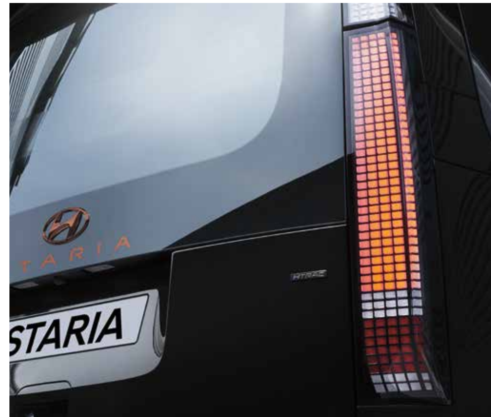
Zadní sdružené svítlny s parametrickými LED pixely
