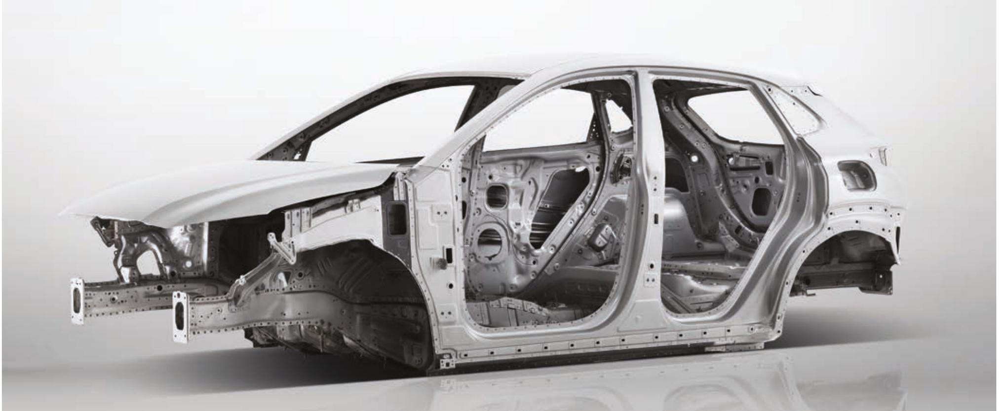
La estructura de la cabina está diseñada para dispersar la energía en caso de colisión, reduciendo así el impacto a los ocupantes
