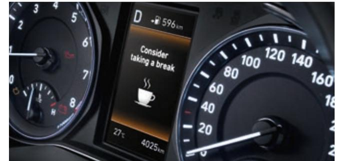
**Sistema de detección de fatiga del conductor (DAW)**
