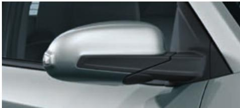
Espejos retrovisores eléctricos ajustables y calefactables con indicador LED
