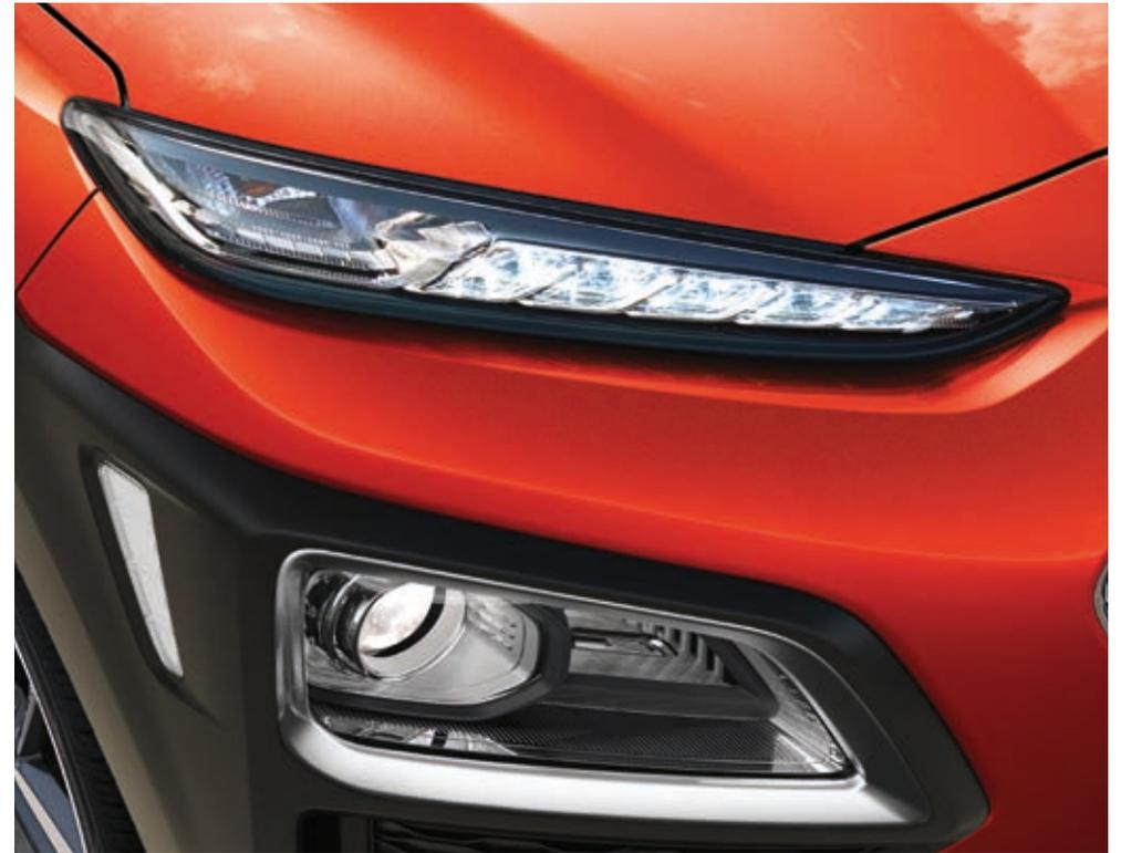
Diseño de doble faro: luces de conducción diurna LED y faros Full LED
