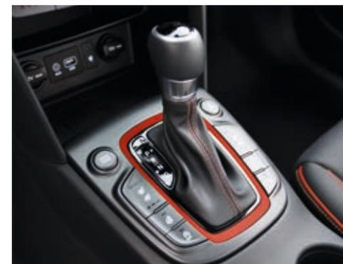
Transmisión automática de doble embrague DCT y 7 velocidades (1.6 TGDí 176cv y 1.6 CRDí 136cv)
