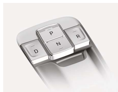
Włączyć tryb P przekładni redukcyjnej (przycisk P).
