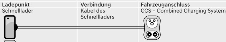
Der KONA Electric kann an einem Gleichstrom-Schnelllader (DC) mit bis zu 75 kW Leistung geladen werden. Die Ladegeschwindigkeit ist zu Beginn am höchsten und nimmt dann allmählich ab. Ein Aufladen der Batterie auf über 80% ist also möglich, aus Zeit- und Kostengründen jedoch nicht mehr optimal. Sollen über kurze Zeit lange Distanzen zurückgelegt werden, ist es oftmals effizienter, den Ladevorgang bei maximal 80% Ladezustand zu stoppen.
