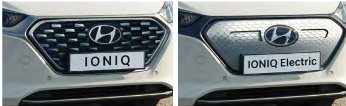
Flap attivi, integrati nella griglia frontale, si aprono e chiudono automaticamente per migliorare i flussi aerodinamici.
