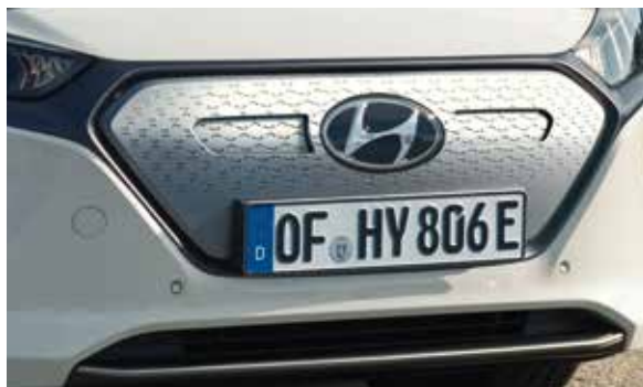
Luftspjeld integrert i grillen åpnes og lukkes automatisk for å optimere aerodynamikken.
