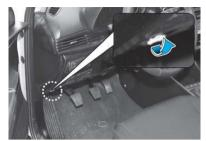
Tirer sur le levier de déverrouillage du capot. Le capot doit s'ouvrir légèrement.
