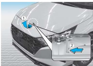
Eleve ligeramente el capó, tire del enganche (1) situado en el interior del centro del capó y levante el capó (2)
