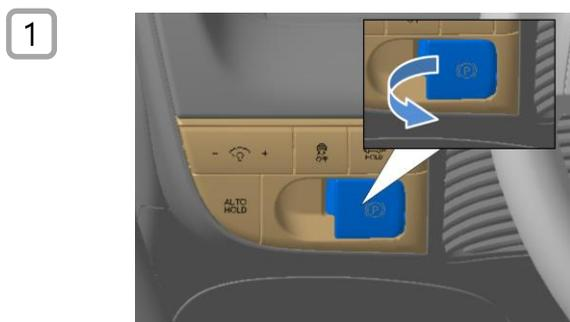
1. Calce las ruedas y tire del interruptor para poner el freno de estacionamiento.
