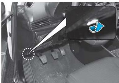
Tire de la palanca de desbloqueo para desenganchar el capó. El capó debería abrirse ligeramente.
