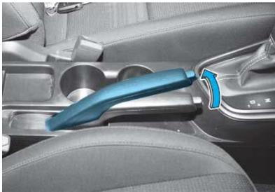
Ziehen Sie die Feststellbremse so weit wie möglich an.
