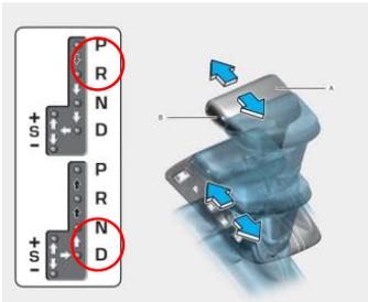
Bei Automatikgetriebe: Schalthebel in Parkstellung (P) bringen
