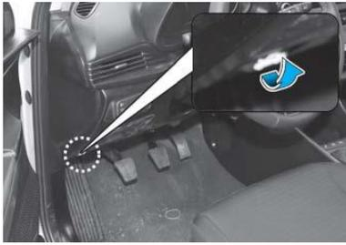
Ziehen Sie den Entriegelungshebel zur Entriegelung der Motorhaube. Die Motorhaube sollte leicht aufspringen.
