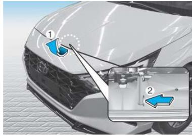
Heben Sie die Motorhaube leicht an, drücken Sie die sekundäre Verriegelung (1) in der Mitte der Haube nach oben und heben Sie die Haube (2) an.
