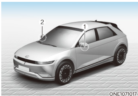
[1], [2]: Surround-zijzichtcamera (de camera bevindt zich aan de onderkant van de spiegel)
