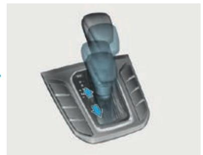
Coloque la palanca de cambios en la posición de aparcamiento (P)
