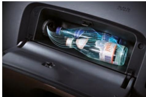
**Ganterera refrigerada.** El compartimento de la guantera posee un inteligente diseño que permite mantener las bebidas siempre frescas.
