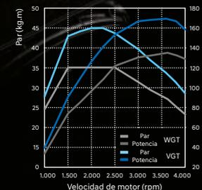
Motor diésel 2.5 CRDi con dos variantes: con WGT: 100kW (136cv) con cambio manual de 6 velocidades, o con VGT: 125kW (170cv) con cambio automático de 5 velocidades.
