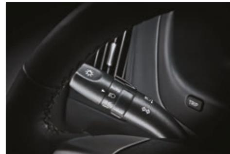
**Sensor de luces.** Olvidate de encender y apagar las luces de cruce de tu H-1 Travel gracias al sensor que detecta la oscuridad y las enciende automáticamente.
