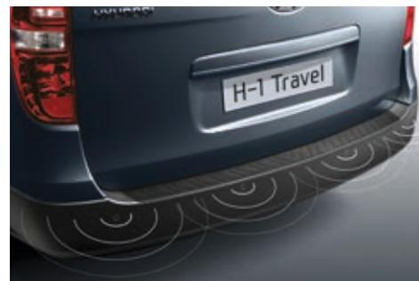
Sensor de aparcamiento trasero. Los sensores ubicados en el parachoques trasero emiten una alarma sonora al detectar que el vehículo se aproxima a un objeto oculto a la vista del conductor.
