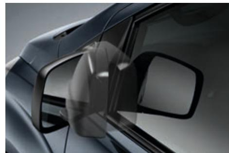
Espejos retrovisores plegables eléctricamente. Los espejos exteriores eléctricos de la H-1 se abaten para protegerlos y ayudar en maniobras de estacionamiento.
