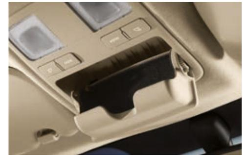
**Compartimento portagafas y luz de mapas.** La consola de techo se abre hacia abajo para guardar unas gafas.
