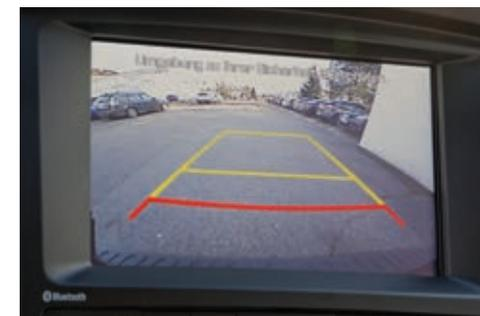
Cámara de visión trasera. Se activa cuando el conductor acciona la marcha atrás, y refleja en la pantalla del navegador la imagen para facilitar el aparcamiento.
