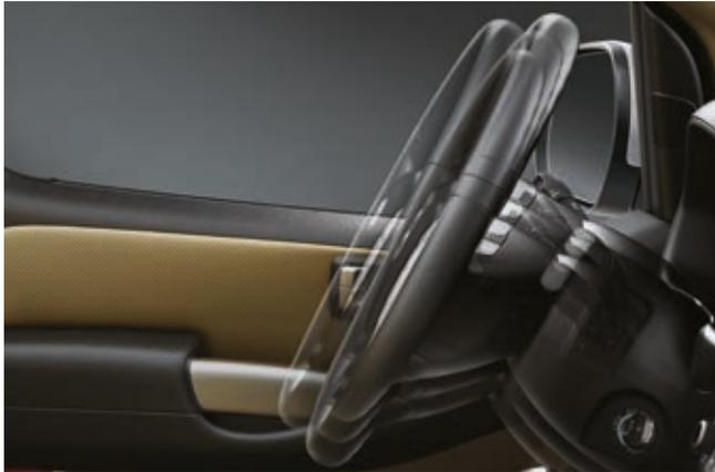
Volante regulable en altura y en profundidad
