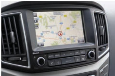
**Sistema de navegación integrado.** Con pantalla táctil de 17,8 cm (7 pulgadas) y TomTom Live Services. Incluye también conexiones USB/AUX.
