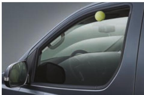
Ventanillas de seguridad. Los sensores de seguridad en la ventanilla del conductor previenen daños personales: cada vez que se detecta un obstáculo la ventana se abre automáticamente.
