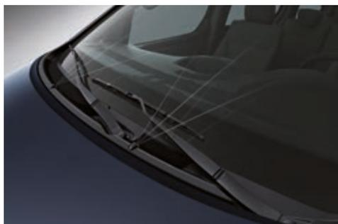
Lavaparabrisas de agua de 3 vías. Hay tres lavaparabrisas de alta presión para rociar líquido de lavado en el parabrisas cuando éste se ensucia.
