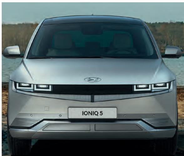
Le face avant se caractérise par sa calandre en V, ses feux avant Bi-LED et ses feux de jour à LED de type « Pixel ». Le style high-tech est souligné par le capot monobloc et par les prises d'air actives en bas du bouclier.
