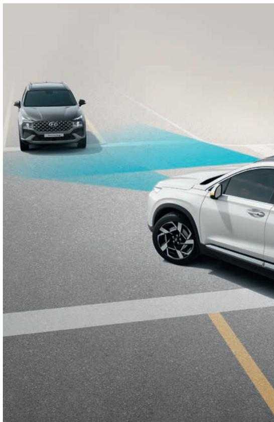
**Freinage d'urgence autonome avec fonction intersection.**
