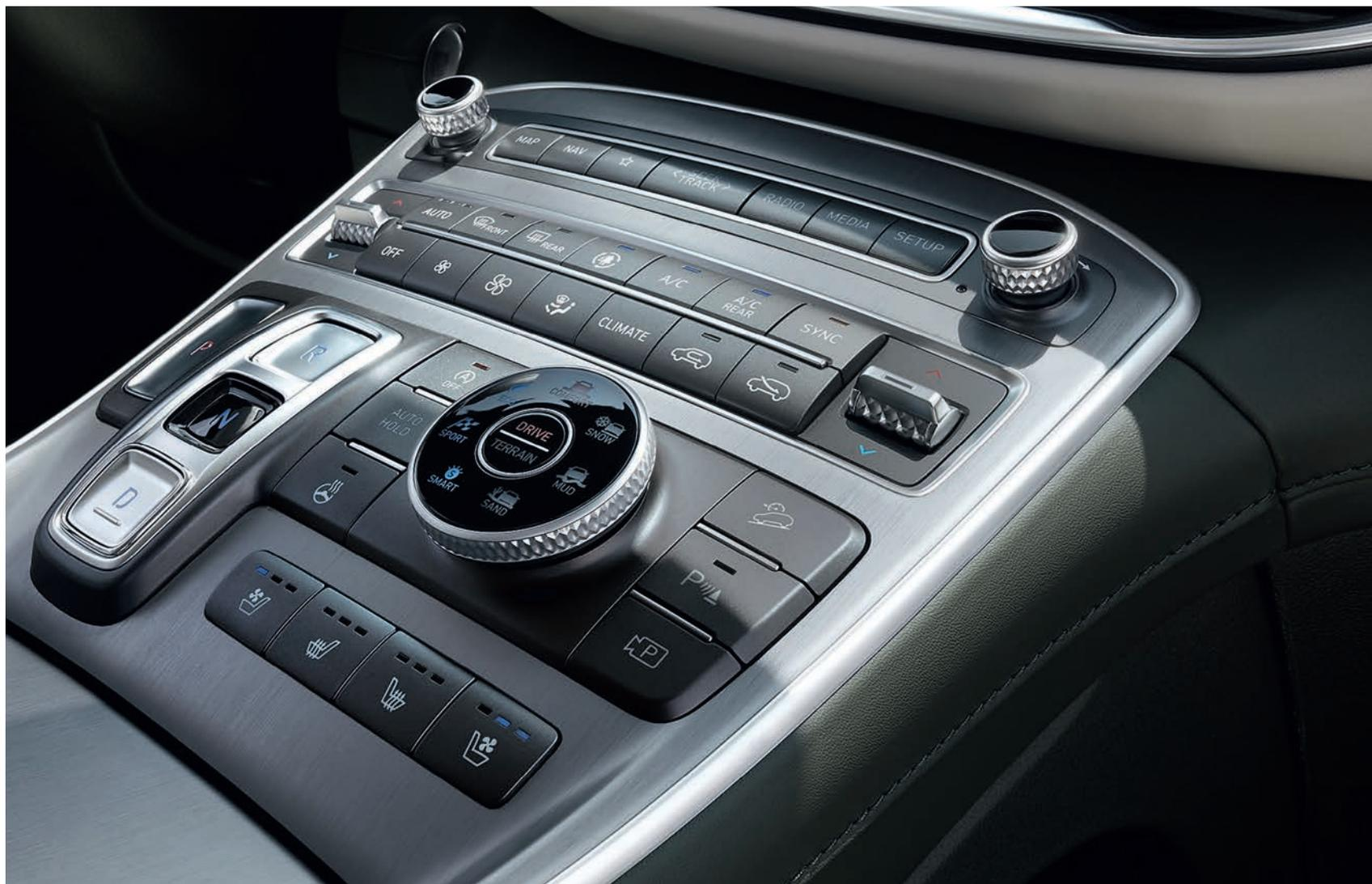
Console centrale flottante avec transmission à commande électrique.
