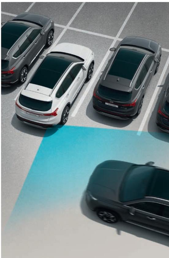
**Alerte de circulation transversale à l'arrière avec fonction freinage.**
