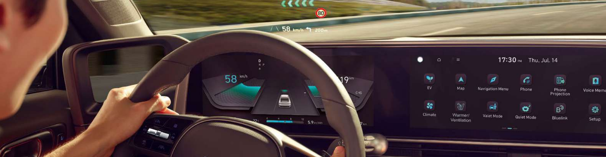
Head-up display avanzato. Questa funzione intelligente trasforma essenzialmente il parabrezza in uno schermo virtuale in grado di farvi leggere informazioni come la navigazione o gli avvisi di sicurezza senza distogliere lo sguardo e l'attenzione dalla strada.
