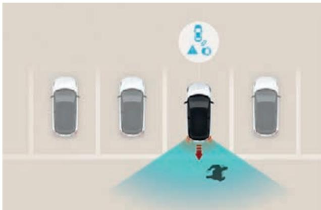
**Aide au parking arrière avec freinage automatique.**
