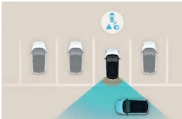
**Alerte de circulation transversale arrière avec freinage automatique.**
