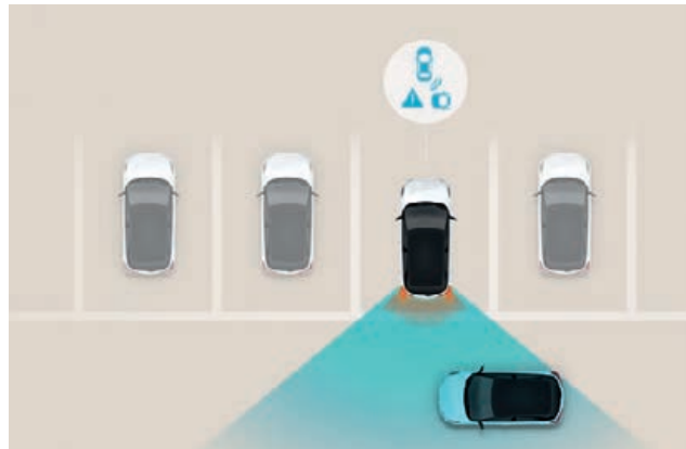
Querverkehrswarnung mit Bremsassistent. Droht etwa beim Zurücksetzen in einer unübersichtlichen Situation eine Kollision mit einem Fahrzeug, das sich von der Seite nähert, wird der Fahrer zunächst gewarnt; bei Bedarf werden auch die Bremsen automatisch betätigt.
