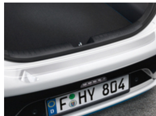
Folia chroniąca tylny zderzak przed uszkodzeniem
