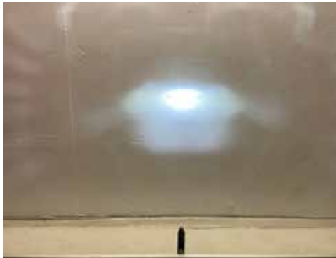
Bild 12a. Spanninga Axendo 60 – ljusbild vägg
