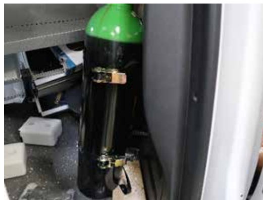
Figur 6. Gasflaska mot mellanvägg
