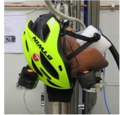
Figur 7. Det hjälmklädda huvudets initiala position vid snett islag på främre delen av hjälmen (rotation kring z) I islag 3 var vinkeln kring y-axeln 70°.
