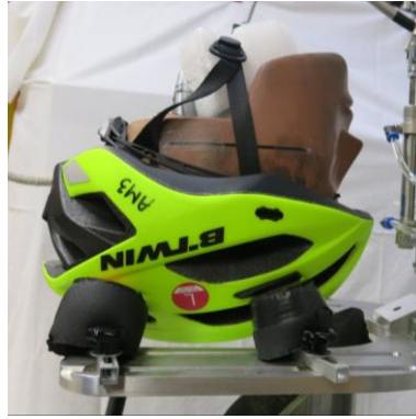
Figur 6. Det hjälmklädda huvudets initiala position vid snett islag på ovandel av hjälmen (rotation kring y) I islag 2 var huvudet roterat 180° och huvudets initiala vinklar kring X-, Y- och Z-axeln var 0°.
