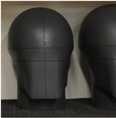
Figur 1. EN 960-provhuvud som används vid certifieringstestning
