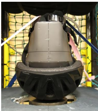
Figur 4. Hjälmprovsningsrigg på RISE som används för det raka islaget
