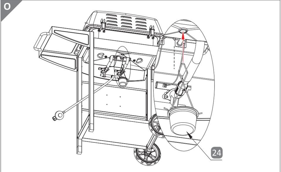
1. Hängen Sie die Fettauffangschale **24** unter dem Gehäuse **7** ein indem Sie sie durch die Öffnung schieben bis sie arretiert ist.
