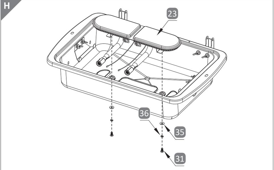
1. Befestigen Sie den Brenner **23** mit je 2 Schrauben M6 x 16 **31**, Unterlegscheibe M6 **35** und Federring M6 **36**.
