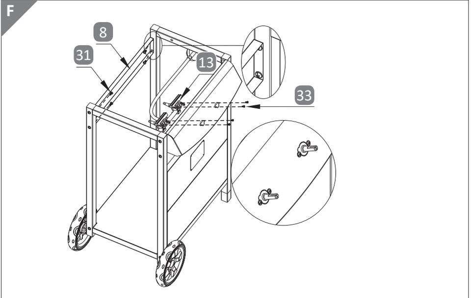
1. Montieren Sie das Brennerventil **13** mit 4 Schrauben **33** an der Reglerpaneel **10** wie auf der Abbildung gezeigt.
