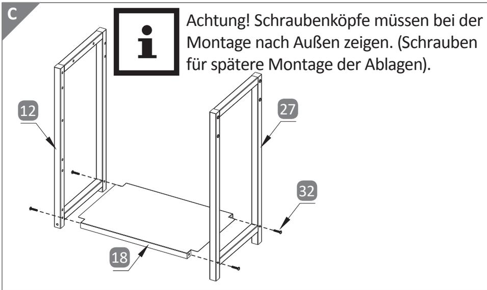
1. Verbinden Sie die Bodenplatte **18** zwischen dem linken und rechten Seitenteil **12** und **27**. Verwenden Sie 4 Schrauben M6 x 20 **32**.
