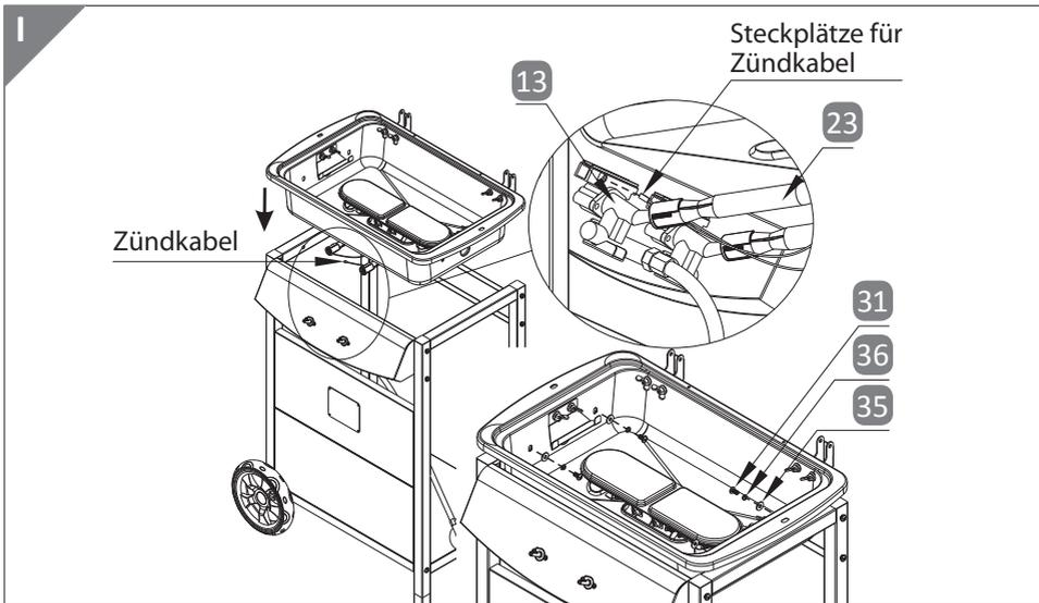
1. Verbinden Sie das Brennerventil **13** mit den Brennern **23** wie auf der Abbildung gezeigt.
