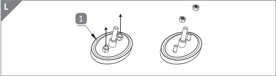
1. Nehmen Sie das Thermometer **1** zu Hand und lösen die werkseitig vormontierten Muttern von den Gewindestiften.
