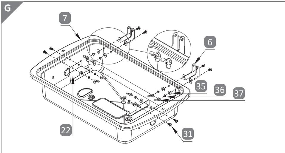
1. Legen Sie sich für die folgenden Montageschritte 8 x die Schrauben M6 x 16 **31**, die Unterlegscheibe M6 **35**, den Federring M6 **36** und die Flügelmutter M6 **37** zurecht.
