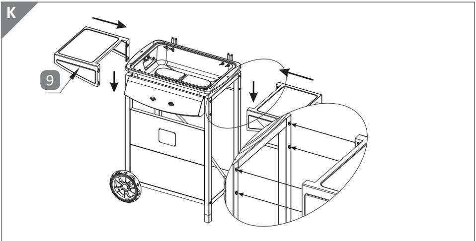
1. Hängen Sie die beiden Ablagen **9** und **25** an den werkseitig vormontierten Schrauben an den beiden Seitenteilen **12** und **27** ein (s. **Abbildung**).
