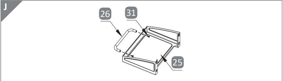
1. Montieren Sie den Ablagegriff **26** mit 2 Schrauben M6 x 16 **31** an der rechten Ablage **25**.
