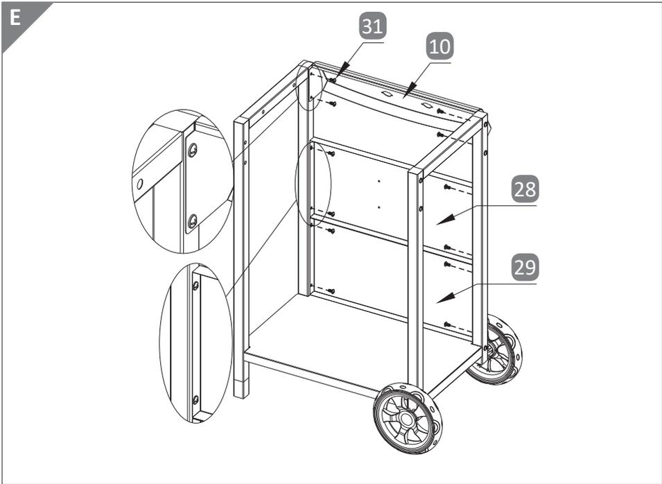
1. Montieren Sie Reglerpanele **10**, die obere Frontblende **28** und die untere Frontblende **29** wie auf der Abbildung gezeigt mit 12 Schrauben M6 x 12 **31**.
