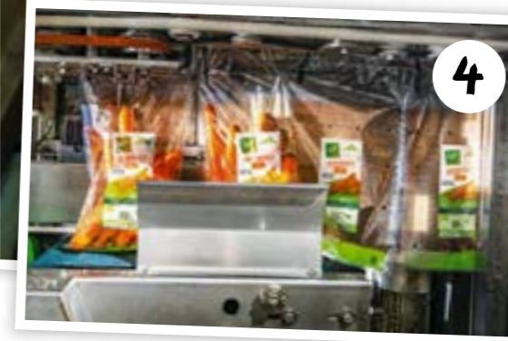
4. Die Möhren werden gewaschen, sortiert, kalibriert und in der Verpackungsmaschine abgepackt.
