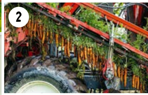
2. Die Möhren werden zu den Messern hochgezogen. Dann wird das Laub abgetrennt.
