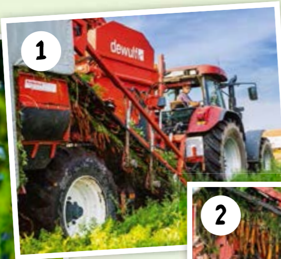
1. Ein sogenannter Klemmbandroder lockert den Boden und hebt die Möhren anschließend samt Laub heraus.
