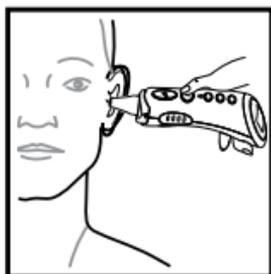
6. Halten Sie das Thermometer so, dass die Messspitze direkt auf das Trommelfell im Innenohr gerichtet ist (siehe **Abb. B**). Führen Sie die Temperaturmessung möglichst immer in gleicher Weise am gleichen Ohr durch.
