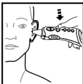
Ein Signalton zeigt an, dass die Messung beginnt. Nach ca. 2 Sekunden bestätigt ein doppelter Signalton, dass die Temperaturmessung beendet ist. Das Symbol (🔊) **18** und die gemessene Ohrtemperatur werden auf dem Display **1** angezeigt. Gleichzeitig leuchtet die Hintergrundbeleuchtung **2** und der Leuchtring auf und signalisiert, wie die gemessene Temperatur ausgefallen ist, siehe Kapitel „Anzeigen zur Körpertemperatur“.
