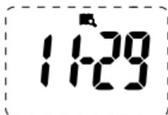
Durch jedes weitere Drücken der Taste MEM werden absteigend zuerst kurz die Nummer und dann die gespeicherten Daten des nächsten Speichereintrags angezeigt. Wenn der älteste Speichereintrag mit der Nummer 1 erreicht ist, schaltet die Anzeige nach erneutem Drücken der Taste MEM zurück in den Bereitschaftsmodus und erst nach nochmaligem Drücken der Taste MEM wieder zum jüngsten Eintrag (z. B. 8) usw.
