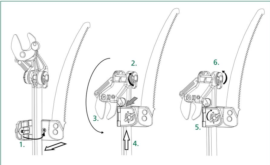
Abbildung 2: Sägeblatt befestigen
