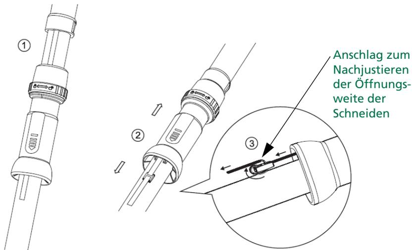
Abbildung 4: Schnittweite justieren
