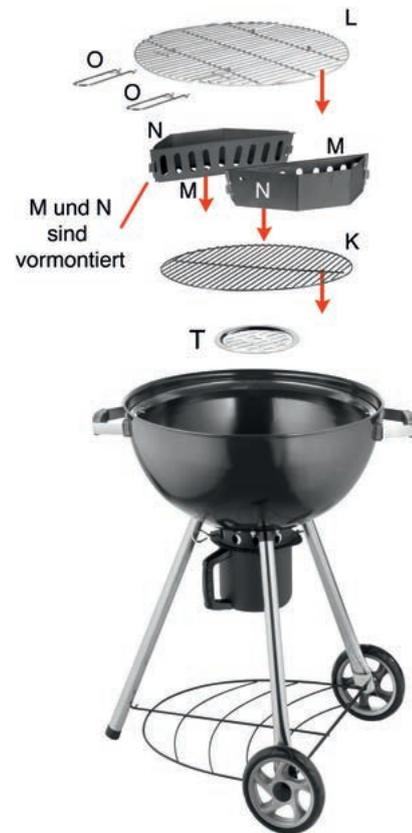
9. Legen Sie das **Aschegitter (T)** lose über das Loch des **Aschebehälters**. Nutzen Sie entweder die zwei **Kohleabstandshalter (M+N)** für einen indirekten Grillvorgang oder alternativ das **Kohlerost (K)** für einen normalen Grillvorgang. (Bild 5)
