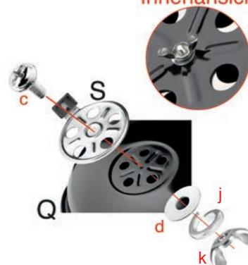
Zur Montage der Lüftungsregelung folgen Sie bitte der obigen Abbildung.
