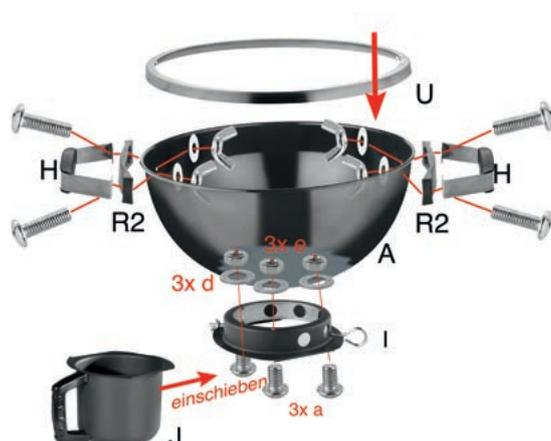
3. Befestigen Sie die **Griffe (H)** mit **Unterlegscheibe (d)**, **Schraube (b)**, **Flügelmutter (g)** und **Hitzeschutz (R2)** an der **Unterschale (A)**. Bitte beachten Sie, dass die **Grillrosthalterung (U)**, innen noch dazwischen gesetzt werden muss bevor die **Flügelmutter (g)** endgültig festgezogen werden kann. Somit ist die **Grillrosthalterung (U)** nun fest mit den Griffen verbunden. (Bild 3)
