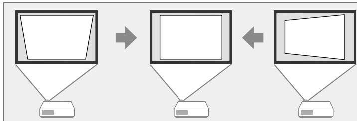
Über die Trapezkorrektur-Tasten können Sie Bilder um bis zu 30 ° nach rechts, links, oben oder unten korrigieren.
