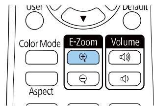
Das projizierte Bild wird vergrößert, wobei die Mitte des Bildes zentriert bleibt. Sie können das Bild in 25 Schritten ein- bis vierfach vergrößern.
