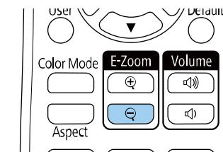
Das projizierte Bild wird verkleinert. Sie können das Bild stufenweise zwischen 100 und 50 % verkleinern.
