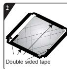
Entfernen Sie das Oberflächenpapier auf dem doppelseitigen Klebeband an vier Seiten der Bodenplatte.
