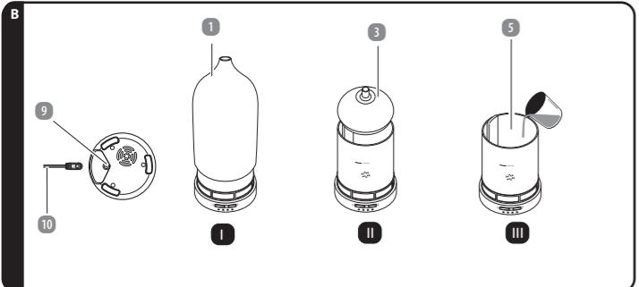
1. Verbinden Sie den Netzadapter **10**, mit dem Produkt an dem Anschluss Netzkabel **9**.
