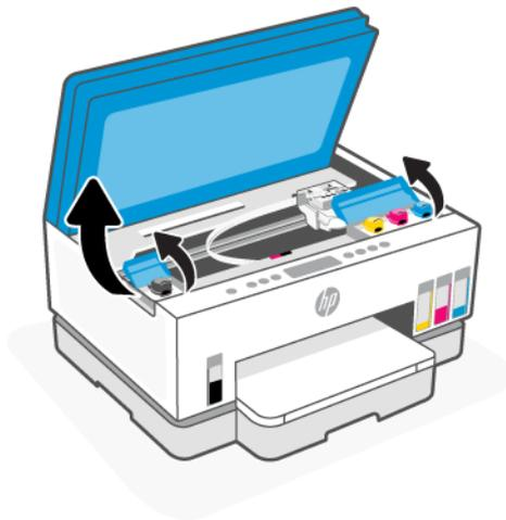
2. Entfernen Sie die Kappe des Farbbehälters, den Sie befüllen möchten.
