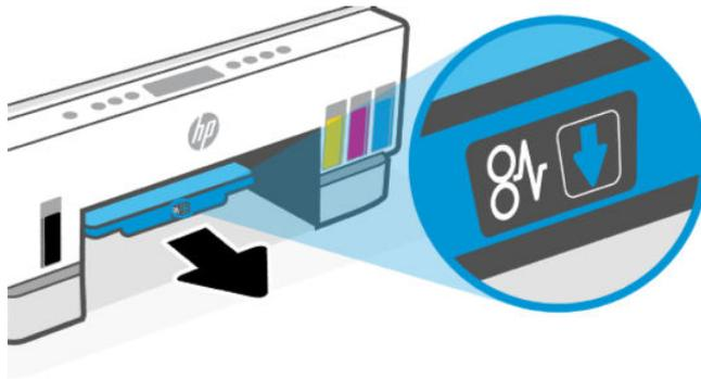
4. Entfernen Sie das eingeklemmte Papier.
