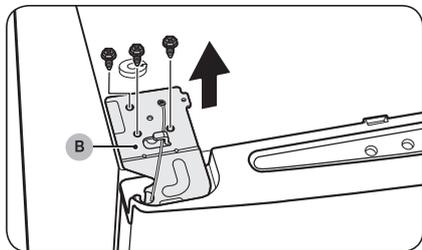
3. Entfernen Sie die Schrauben zur Befestigung des oberen Scharniers (B) mit einem Steckschlüssel (10 mm).
