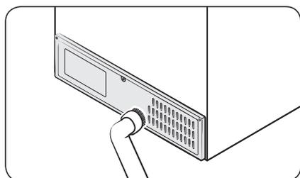
Um Kabel und freiliegende Teile der Rückwand frei von Schmutz zu halten, saugen Sie die Rückwand ein- bis zweimal pro Jahr mit dem Staubsauger ab.
