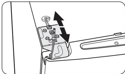
2. Trennen Sie die Kabel an der Oberseite der Kühl-/Gefrierkombination.
