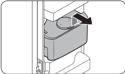
1. Fassen Sie den Tank an den beiden seitlichen Handgriffen und heben Sie ihn heraus.
