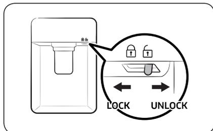
4. Um Wasser auszugeben, halten Sie ein Glas unter den Bezugshahn, und drücken Sie es vorsichtig gegen den Hebel am Wasserspender. Stellen Sie sicher, dass der Wasserspender nicht verriegelt ist.
