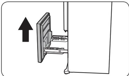
3. Heben Sie die Tür des Gefrierabteils zum Entfernen aus den Schienen.
