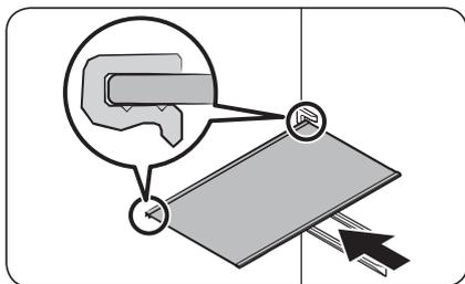
Bevor Sie den Fachboden einsetzen, überprüfen Sie die Form der Rückseite des Fachbodens. Setzen Sie dann den Fachboden in der umgekehrten Reihenfolge des Ausbaus ein.
