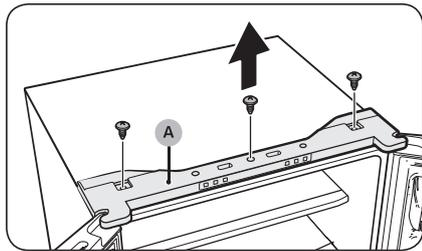
1. Entfernen Sie die Schrauben zur Befestigung der oberen Abdeckung (A) mit einem Kreuzschlitzschraubendreher.
