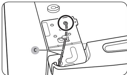
4. Entfernen Sie die Schrauben zur Befestigung der des Erdungskabels (C) mit einem Kreuzschlitzschraubendreher.
