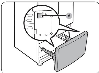
1. Ziehen Sie die Schienen des Schubfachs im Gefrierabteil vollständig heraus.
