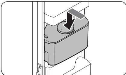
3. Setzen Sie den Wassertank danach wieder ein und schließen Sie die Tür. Stellen Sie sicher, dass der Bezugshahn des Wassertanks nach vorne zeigt.
