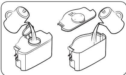
2. Sie können bis zu 4 Liter Trinkwasser in den Wassertank füllen. Sie können entweder die obere Kappe oder den Deckel entfernen und Wasser eingießen.
