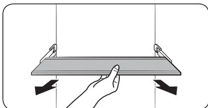
Um einen Fachboden zu entfernen, müssen Sie die Tür des Kühlabteils vollständig öffnen. Heben Sie den Fachboden vorn vorsichtig an und ziehen Sie ihn heraus.
