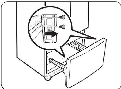
2. Verwenden Sie einen Steckschlüssel (10 mm), um die 4 Schrauben zur Befestigung der Tür zu entfernen.
