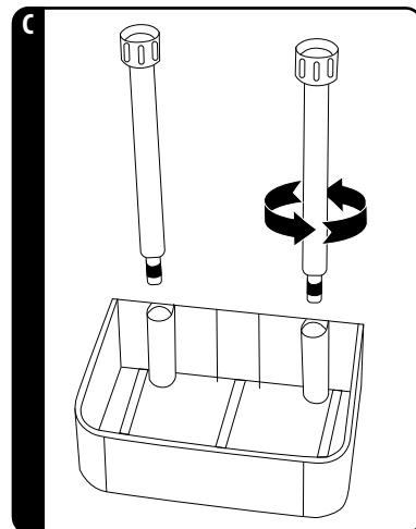
3. Placez les tubes de la poignée 5 sur les barres verticales 3, faites glisser les embouts 4 hacia arriba vers le haut jusqu'au filetage et vissez-les (voir figure D).
