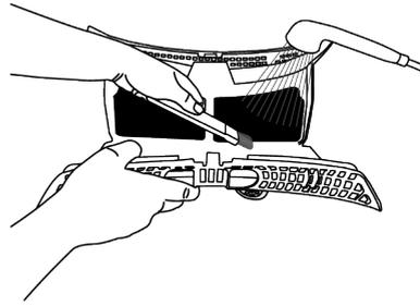
6. Setzen Sie die Flusensiebe aufeinander und setzen diese wieder im Trockner ein.
