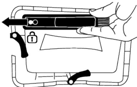
Reinigen Sie die Faser auf der Metalloberfläche des Kondensators mit einem feuchten Tuch oder einer Bürste am Luftleitblech nach oben und unten. Reinigen Sie nicht von links nach rechts, da dies die Metallplatten des Kondensators beschädigen kann.
