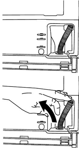
2. Stecken Sie das eine Ende des mit dem Trockner gelieferten Wasserablaufschlauchs an die Stelle, an der Sie den Schlauch des Trockners entfernt haben.
