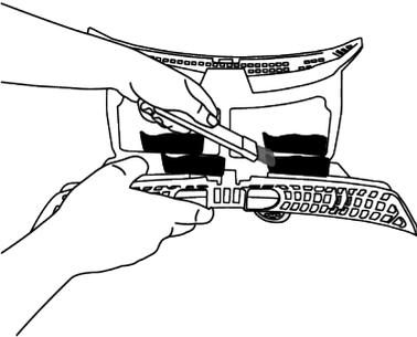
5. Reinigen Sie beide Filter unter fließendem Wasser in umgekehrter Richtung der Faseransammlung mit der Hand oder mit einer weichen Bürste. Trocknen Sie die Filter, bevor Sie sie wieder einsetzen.
