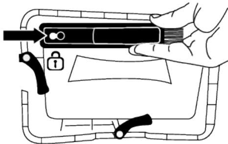
Bringen Sie nach dem Reinigungsvorgang die Luftumlenkungsabdeckung wieder an ihrem Platz an, schließen Sie die Verriegelungen, indem Sie sie bewegen, und schließen Sie die Klappe.
