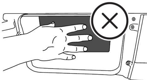
**i** Wenn die Luftleitblechabdeckung entfernt wird, befindet sich normalerweise Wasser am Kunststoffabschnitt vor dem Kondensator.
