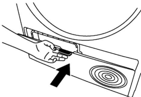
**HINWEIS:** Sie können von Hand reinigen, sofern Sie Schutzhandschuhe tragen. Versuchen Sie nicht, mit bloßen Händen zu reinigen. Die Kondensatorlamellen können Ihre Hände verletzen. Die Reinigung von links nach rechts kann die Kondensatorlamellen beschädigen. Dies kann zu Trocknungsproblemen führen.
