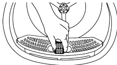
3. Entfernen Sie den zweiten Teil (Außenfilter), indem Sie ihn nach oben ziehen.
