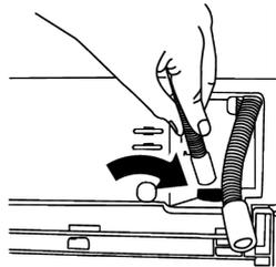
3. Befestigen Sie das andere Ende des Wasserablaufschlauchs an der direkten Abwasserableitung oder einem Waschbecken.
