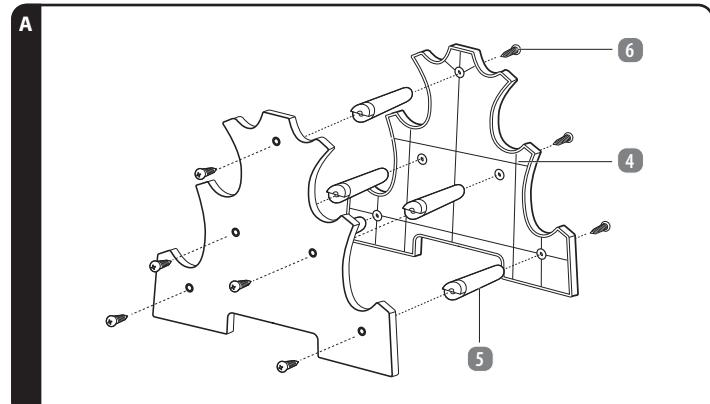
1. Fissare i raccordi **5** alle rastrelliere manubri **4** attraverso i fori previsti a tal fine con le viti **6** (vedi fig. A). Serrare leggermente le viti utilizzando la chiave a brugola **7** in dotazione.
