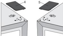
Nehmen Sie die (rechte) Abdeckung (4) aus dem Beutel und platzieren Sie sie an der Stelle, von der das obere Scharnier entfernt wurde. Entfernen Sie die Abdeckung von der anderen Seite (5), auf die das Scharnier gesteckt werden soll, und bewahren Sie sie auf.
