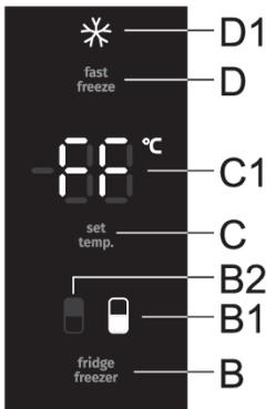
**Ausschalten:** wenn der Kühlbehälter aktiv ist (**B2**leuchtet), drücken Sie zuerst die **B**-Taste, um zum Gefrierbehälter zu wechseln (**B1** leuchtet auf), und drücken Sie dann die **D**-Taste, um die Funktion zu deaktivieren.
