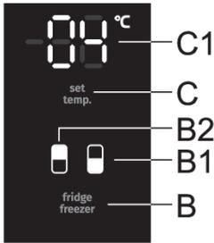
In diesem Modell können Sie zwischen der Einstellung der Temperatur des Kühlschranks und der Temperatur des Gefrierbehälters wechseln. Drücken Sie dazu die **B**-Taste. Das Symbol für den gewünschten Behälter leuchtet: **B1** für den Gefrierbehälter und **B2** für den Kühlbehälter.
