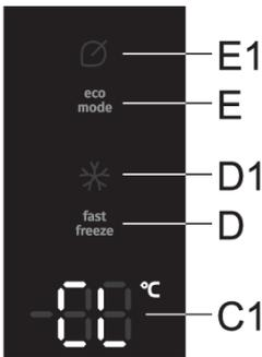
**Einschalten:** Um die Kindersicherung zu aktivieren, drücken Sie die **E**-Taste und halten Sie diese eine Weile (3 Sekunden) gedrückt. **CL** erscheint kurz auf der **C1**-Anzeigeeinheit angezeigt.
