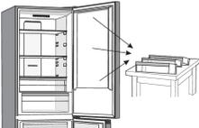
Stellen Sie das Gerät aufrecht auf. Öffnen Sie die obere Tür und entfernen Sie die Türablagen (um eine Beschädigung während der Prozedur zu vermeiden). Schließen Sie die Gerätetür.
