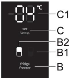
Die Temperatur im **Kühlteil** kann eingestellt werden, sobald das Symbol **B2** beleuchtet ist. Stellen Sie die gewünschte Temperatur durch kurzes Drücken der Taste **C** ein.
