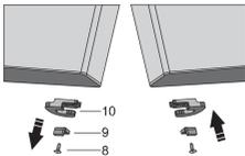
Lösen Sie die Schraube (8) und entfernen Sie den Türhalter (10) und den Türanschlag (9). Verwenden Sie dann die Schraube (8), um den im Beutel enthaltenen Türhalter und den Türanschlag (9) zu montieren. Bewahren Sie den Türhalter (10) für den Fall auf, dass Sie ihn später benötigen.
