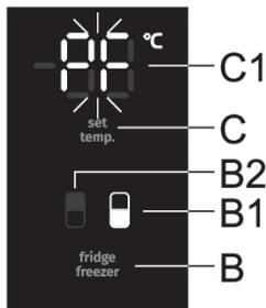
Falls die Temperatur im Gerät während eines Stromausfalls den Alarmwert erreicht, wird der Hochtemperaturalarm aktiviert, wenn die Stromversorgung wieder hergestellt wird. Ein akustischer Alarm ertönt und auf der Anzeige **C1** blinkt das Symbol **PF**.
