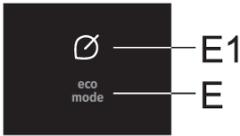
**Einschalten:** Um die **Eco** Funktion zu aktivieren, drücken Sie kurz die Taste **E**. Das Symbol **E1** leuchtet auf. Wenn diese Funktion aktiviert ist, arbeitet das Gerät unter optimalen Einstellungen.
