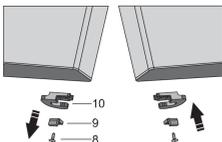
Legen Sie die untere Tür auf eine weiche Unterlage. Lösen Sie die Schraube (8) und entfernen Sie den Türhalter (10) und den Türanschlag (9). Verwenden Sie dann die Schraube (8), um den im Beutel enthaltenen Türhalter und Türanschlag (9) zu montieren. Bewahren Sie den Türhalter (10) für den Fall auf, dass Sie ihn später benötigen.
