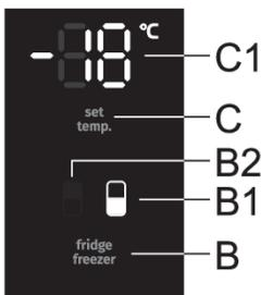
Die Temperatur im **Gefrierteil** kann eingestellt werden, sobald das Symbol **B1** aufleuchtet. Stellen Sie die gewünschte Temperatur durch kurzes Drücken der Taste **C** ein.
