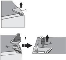
Entfernen Sie die obere Scharnierabdeckung (1). Seien Sie vorsichtig, damit Sie den Steckverbinder (A) nicht beschädigen. Steckverbinder (A) abziehen.
