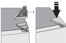
Entfernen Sie die obere Scharnierabdeckung (1).
