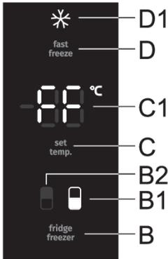
**Aktivierung:** drücken Sie die **D**-Taste, um die Funktion des intensiven Einfrierens (SuperFreeze) zu aktivieren. Sie hören einen Signalton und die Anzeigen **B1** und **D1** leuchten auf. **FF** erscheint auf dem Display **C1**. **FF** leuchtet, solange die Funktion aktiv ist, wenn die Anzeige **B1** mit der Taste **B** ausgewählt ist.
