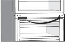
Entfernen Sie die mittlere Scharnierabdeckung und stecken Sie sie auf die gegenüberliegende Seite.
