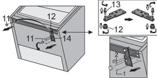
Lösen Sie die drei Schrauben des unteren Scharniers (14) und entfernen Sie es. Entfernen Sie den zusätzlichen Fuß (12) vom unteren Scharnierstift (13). Schrauben Sie den Stift (13) aus dem unteren Scharnier heraus und schrauben Sie ihn zusammen mit dem zusätzlichen Fuß (12) auf die gegenüberliegende Seite des Scharniers.
