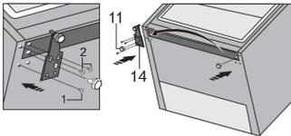
Befestigen Sie das Scharnier (14) mit den Schrauben auf der gegenüberliegenden Seite. Die Schrauben sollten in der in der Abbildung unten gezeigten Reihenfolge angebracht werden. Zuerst Schraube 1 festziehen, dann Schrauben 2. Dann die Stellfüße (11) anschrauben.
