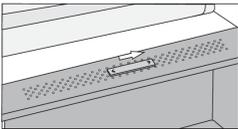
**Position des Feuchtigkeitsreglers rechts:** geschlossen – größere Feuchtigkeit im Fach.
