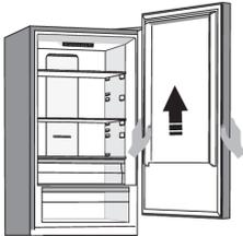
Entfernen Sie die obere Tür vom mittleren Scharnier, indem Sie die Tür vorsichtig nach oben anheben. Legen Sie die Gerätetür auf eine weiche Unterlage.
