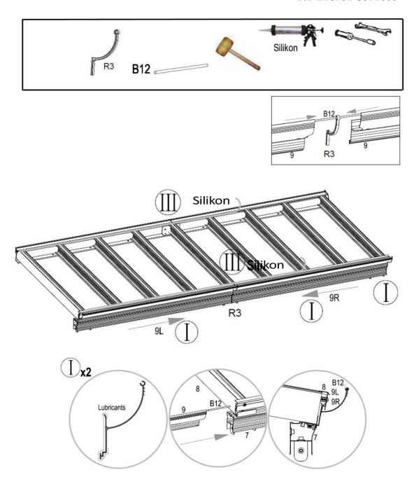
9L und 9R lassen sich leichter installieren, wenn Sie Schmierstoff verwenden.
