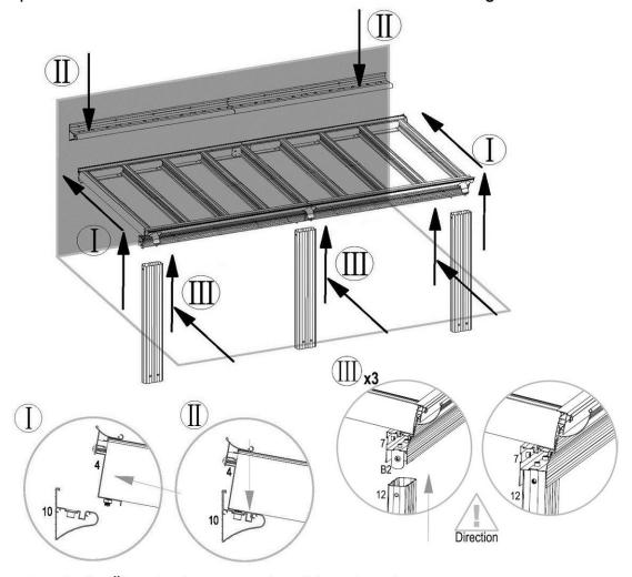
Damit die Überdachung vor dem Verschrauben einen gewissen Halt hat, befindet sich außen an der Wandschiene eine Führung in der die Überdachung eingehängt werden kann.
