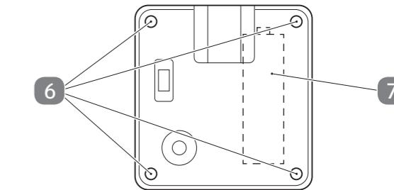
1. Drehen Sie mit einem kleinen Kreuzschlitzschraubendreher die 4 Schrauben **6** heraus, öffnen Sie das Gehäuse und entnehmen Sie den Akku **7**.
