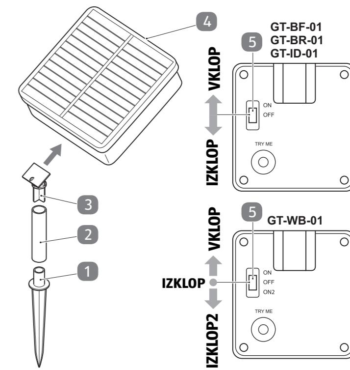
4. Ploščo postavite na poljubno sončno mesto na vrtu. Druga možnost je, da ploščo postavite na balkon ali teraso. Za to uporabite posajen cvetlični lonec ali npr. kabelske vezice, da pokončno cev pritrdite na ograjo.
