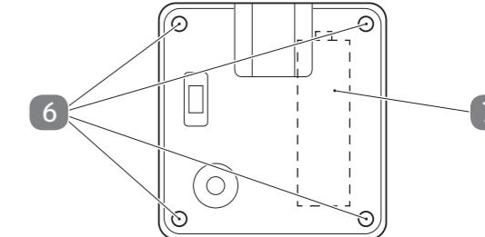
1. Z majhnim križnim izvijačem izvijte štiri vijke 6, odprite ohišje in odstranite baterijo 7.
