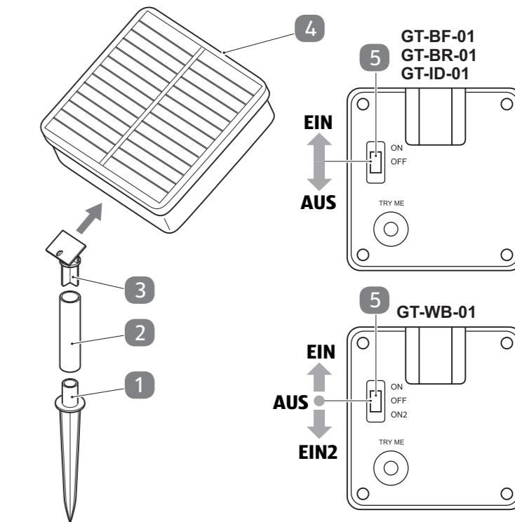
4. Platzieren Sie das Panel an einem beliebigen, sonnigen Platz im Garten. Alternativ lässt sich das Panel auf dem Balkon oder einer Terrasse aufstellen. Benutzen Sie dazu einen bepflanzten Blumentopf oder z. B. Kabelbinder, um das Standrohr an einem Geländer zu befestigen. Beachten Sie stets die Ausrichtung der Solarzelle des Solarpanels **4** nach Süden.
