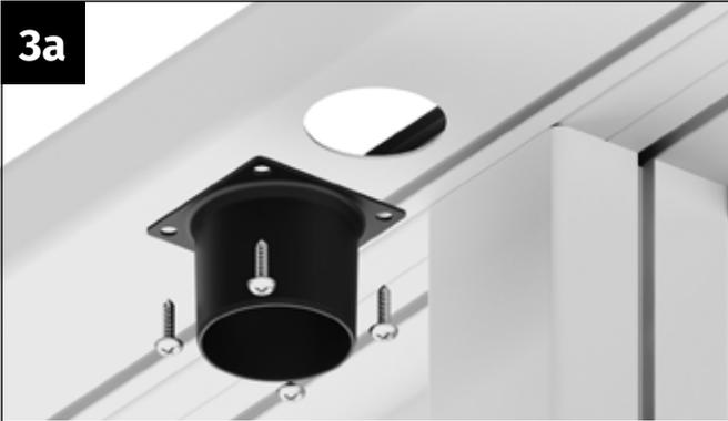
Nehmen Sie einen Ablaufstutzen sowie vier Bohrschrauben 4,8x13 mm zur Hand.
