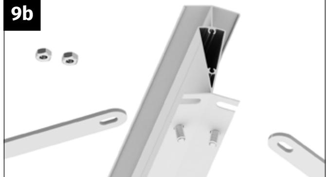
Führen Sie die beiden M6x12 mm Schrauben von außen durch die Löcher des Firstes ein.
