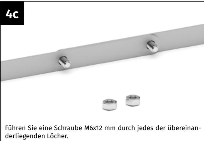
Führen Sie eine Schraube M6x12 mm durch jedes der übereinanderliegenden Löcher.
