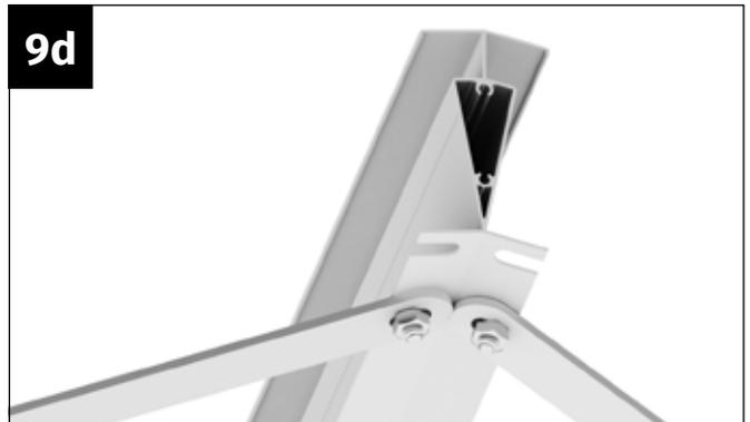
Verschrauben Sie die Windverbände fest mit M6 Flanschmutter am First.
