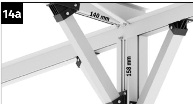
Um die Kopfbänder exakt positioniert zu haben, können Sie sowohl am Pfosten als auch am Sparren eine Markierung anbringen.
