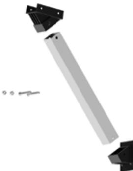
Nehmen Sie ein Kopfbandprofil, einen Kopfbandverbinder CPP208, einen Kopfbandverbinder CPP207, zwei Schrauben M6x50 mm und zwei selbstsichernde Muttern M6 zur Hand.
