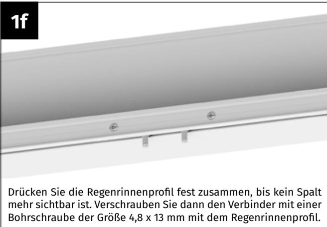
Drücken Sie die Regenrinnenprofil fest zusammen, bis kein Spalt mehr sichtbar ist. Verschrauben Sie dann den Verbinder mit einer Bohrschraube der Größe 4,8 x 13 mm mit dem Regenrinnenprofil.
