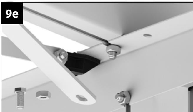
Nehmen Sie für jeden der beiden Windverbände eine M6x12 mm Schraube und eine M6 Flanschmutter zur Hand.
