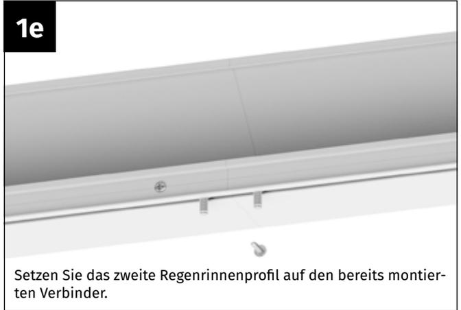
Setzen Sie das zweite Regenrinnenprofil auf den bereits montierten Verbinder.
