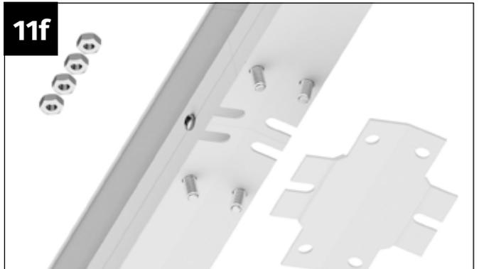
Führen Sie die M6x12 mm Schrauben in die Löcher des Firstes ein.
