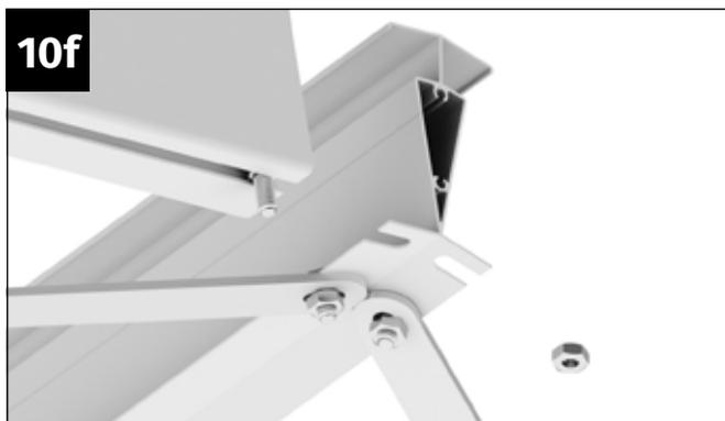
Führen Sie die M6x12 mm Schraube in den Schraubkanal des Außensparrens ein.
