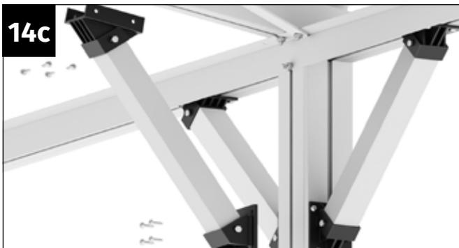
Nehmen Sie ein bereits vorbereitetes Kopfband für die Verbindung des Pfostens mit dem Sparren, sowie acht selbstbohrende Blechschrauben 4,8x22 mm zur Hand.
