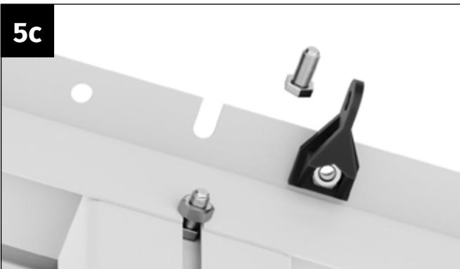
Positionieren Sie das Kunststoffteil CCP209 an der Ausstanzung des Längsträgers.
