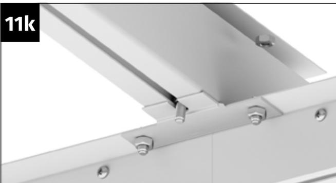
Setzen Sie den Sparren auf den Längsträger und führen Sie die M6x12 mm Schraube in die vorbereitete Ausstanzung des Verbindungsblech ein.
