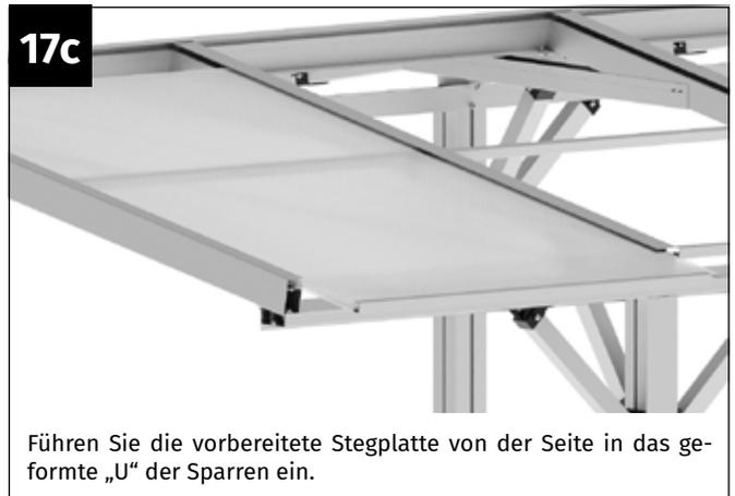
Führen Sie die vorbereitete Stegplatte von der Seite in das geformte „U“ der Sparren ein.
