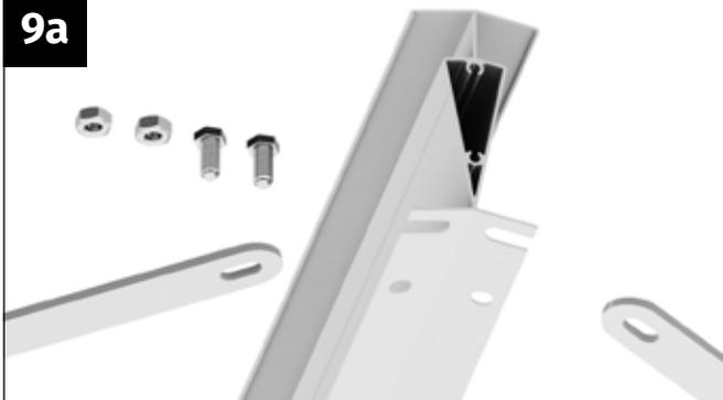
Nehmen Sie zwei Windverbände, zwei M6x12 mm Schrauben und zwei M6 Flanschmutter zur Hand.
