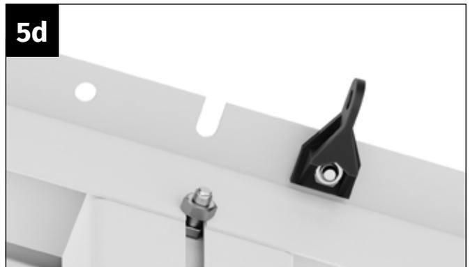
Verschrauben Sie das Kunststoffteil CCP209 fest mit der Schraube M6x12 mm.
