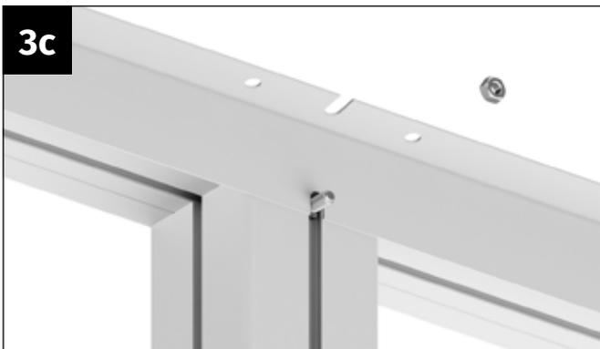
Setzen Sie den Längsträger auf den Pfosten auf und bringen Sie die Schraube in die vorbereitete Ausstanzung des Längsträgers.
