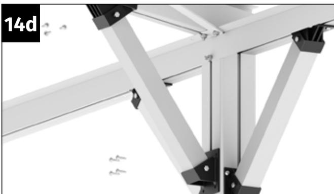
Positionieren Sie das Kopfband für das Verschrauben am Pfosten und am Sparren.
