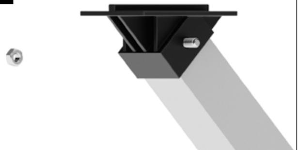
Stecken Sie die Schrauben M6x50 mm durch die Löcher vom Kopfbandprofil und des Kopfbandverbinders.
