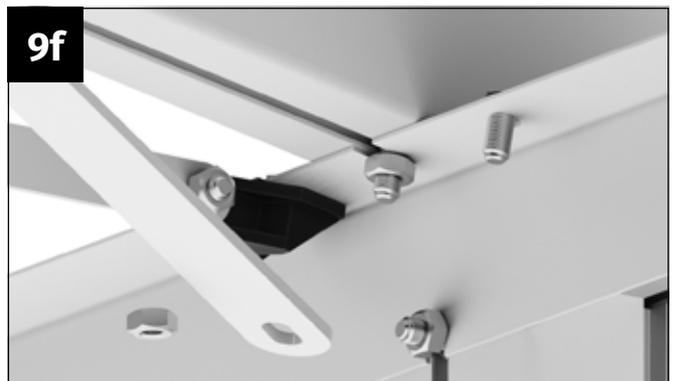
Führen Sie die M6x12 mm Schraube von außen durch das Loch im Längsträger ein.
