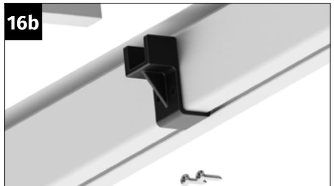
Setzen Sie die Haltestütze von unten auf den Sparren und positionieren Sie sie exakt in der Mitte des Sparrens.
