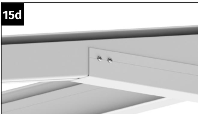
Verschrauben Sie die Zugstrebe an jeder Seite mit vier Bohrschrauben 4,8x13 mm.
