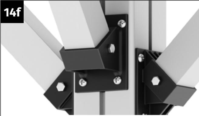
Verschrauben Sie das Kopfband am Pfosten mit den vier Blechschrauben 4,8x22 mm.
