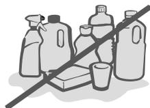
Spülen Sie während der Reinigung nicht direkt mit Wasser oder anderen Flüssigkeiten ab, um Kurzschlüsse zu vermeiden oder die elektrische Isolierung nach dem Eintauchen zu beeinträchtigen.
