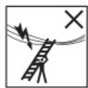
确认作业区域内所有因电气作业工具可能造成的风险，例如：高压架空电线或其他裸露的电气作业工具，当存在电击危险时，请勿使用梯子。
