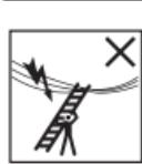
Zjistěte si veškerá rizika daná elektrickými zařízeními v pracovním prostoru, např. venkovní vedení vysokého napětí nebo jiná nezakrytá elektrická zařízení, a žebřík nepoužívejte, pokud hrozí riziko úrazu elektrickým proudem.
