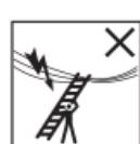
Determine todos os riscos que possam provir de equipamentos elétricos existentes na área de trabalho, por exemplo, linhas aéreas de alta tensão ou outros equipamentos elétricos descobertos e não utilize a escada, se houver risco de choque elétrico.
