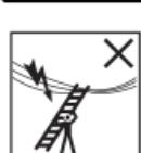
Averiguar todos los riesgos producidos debido a los medios de producción eléctricos en el área de trabajo, p.ej. líneas aéreas de alta tensión u otros medios de producción expuestos y no emplear la escalera cuando existan riesgos por corriente eléctrica.
