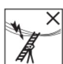
Individuare tutti i rischi derivanti da apparecchiature elettriche nell'area di lavoro, ad es. non utilizzare linee aeree ad alta tensione o altre apparecchiature elettriche esposte e non utilizzare i conduttori se sussiste il rischio di scossa elettrica.
