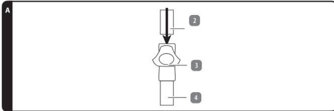
2. Lassen Sie das Oberrohr **2** mindestens 10 cm in das Unterrohr (Erdspieß) **4** gleiten (siehe Abb. A).
