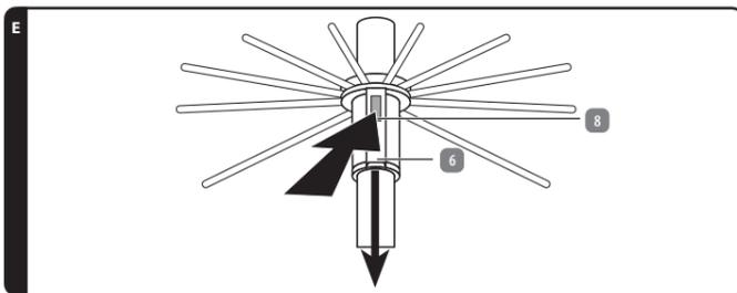
2. Drücken Sie die Auslösetaste **8** und lassen Sie gleichzeitig den Schiebegriff **6** nach unten gleiten (siehe Abb. E).
